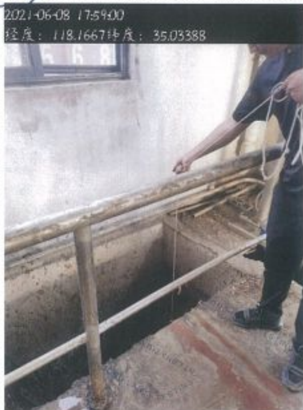
图 9: 厂区污水处理站进口现场采样
